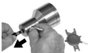
3. Den Systemschlüssel bzw. den Rundstift aus der Öffnung entfernen.
